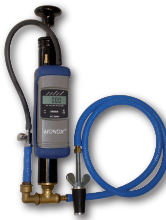
Samenstelling voor het meten van de lekdichtheid (art.nummers 4735330 - 4735830 - 4736025)
