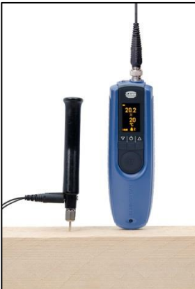
Afbeelding 5-1: Meting loodrecht op de vezelrichting met M 20
