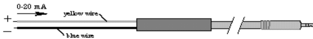
Diagram A - 4-20 mA Input cable
